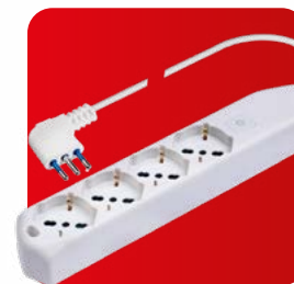
Presa quadrupla pluristandard 2P+T (standard italiano 10/16A e tedesco 16A con terra laterale) con interruttore luminoso, 1,5m cavo con spina 16A 2P+T, IMQ, CE.
