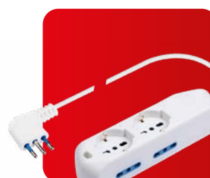
Presa multipla con 4 uscite bivalenti 10/16A 2P+T, 2 uscite 10-16A 2P+T (stand. Italiano 10/16A e tedesco 16A con terra laterale), 1,5m cavo con spina 16A 2P+T, IMQ, CE.
