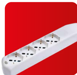
Presa quadrupla pluristandard 2P+T (stand. Ital. 10/16A e ted. 16A con terra lat.), IMQ, CE.
