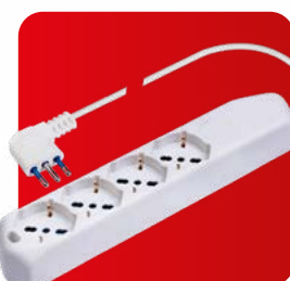
Presa quadrupla pluristandard 2P+T (standard italiano 10/16A e tedesco 16A con terra laterale), 1,5m cavo con spina 16A 2P+T, IMQ, CE.
