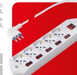
Presa multipla 250V~ con 5 prese 10/16A 2P+T, standard italiano 10/16A e tedesco 16A con terra laterale, 1,5m cavo con spina 16A 2P+T, interruttore luminoso generale e 5 interruttori singoli su ogni presa, IMQ, CE
