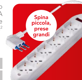
Presa sestupla pluristandard: italiano bivalente 10/16A 2P+T, tedesco 16A 2P+T (terra laterale), con interruttore di sicurezza, 1,5m cavo 3X0,75mm 2 con spina 10A 2P+T, IMQ, CE.
