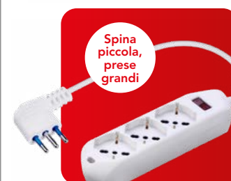
Presa tripla pluristandard: italiano bivalente 10/16A 2P+T, tedesco 16A 2P+T (terra laterale), con interruttore di sicurezza, 1,5m cavo 3X0,75mm 2 con spina 10A 2P+T, IMQ, CE.
