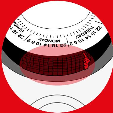
Premere gli interruttori per selezionare gli orari a cui si vuole attivare il dispositivo collegato. Ogni interruttore premuto determina l'accensione del dispositivo collegato per 105 min. Nell'esempio il dispositivo si accenderà per 105 min.
